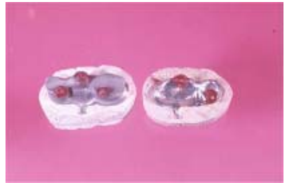
Foto 32 : Bloccaggio dei perni in platino, con relativo rivestimento per saldatura
