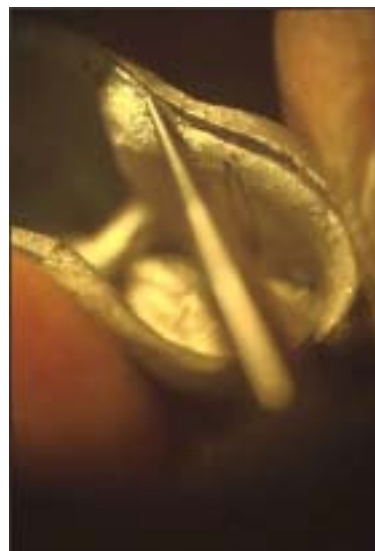
Foto 28 : Rimozione delle imprecisioni legate alla fusione, tramite controllo al microscopio ottico (20x).
