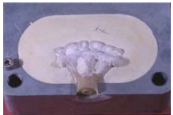
Foto 16 : La resina dopo l'iniezione.
