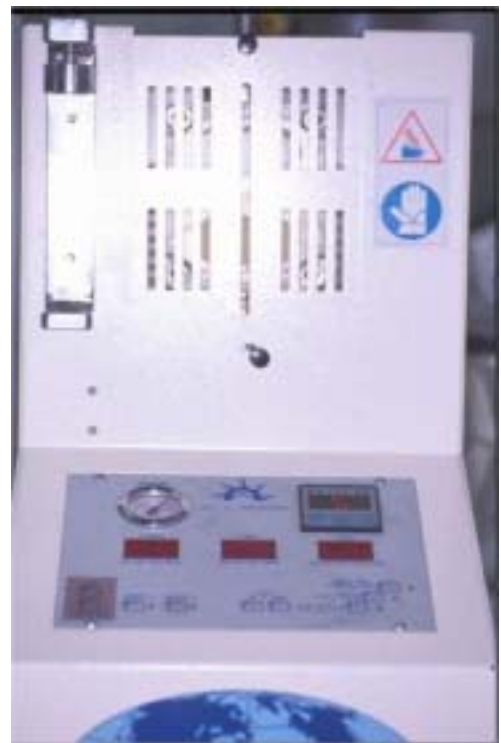
Foto 15 : Iniezione della resina acetlica.
