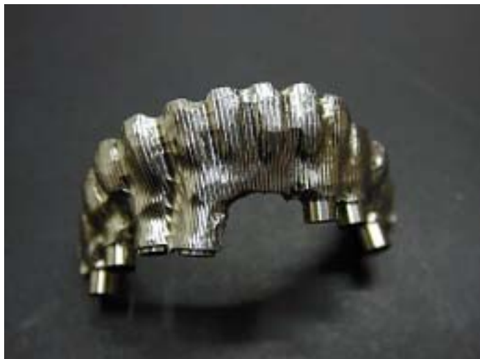
Foto 3 – Travata in titanio puro grado 2 ricavata dal pieno ( All In One ) oggi meglio conosciuta come Implant Bridge appena ricevuta dall'Unità Produttiva (Sweden).
