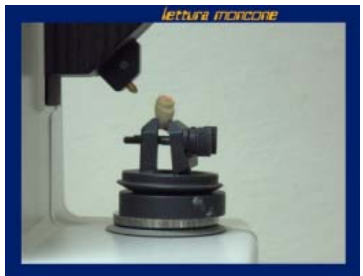
Foto 25 – Visione dell' Holder (posizionatore per monconi per la lettura da parte dello scanner).
