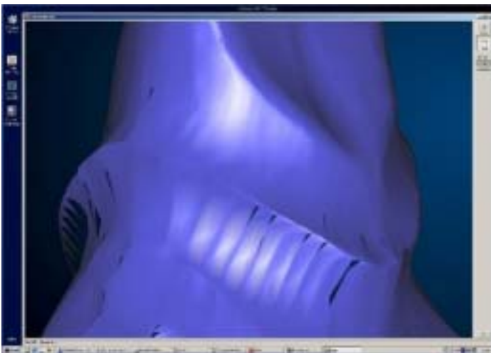
Foto 27 – Una chiara visione del moncone importata nel Software 3D permette una veloce individuazione del margine di chiusura con possibilità di correzione a vari livelli di precisione
