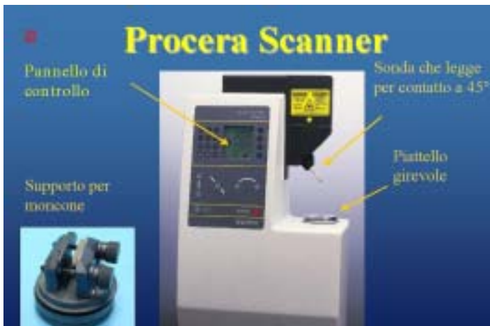
Foto 15 – Visione dello Scanner del Laboratorio Network PROCERA® Per mezzo del quale si ha la scansione dei Monconi.
