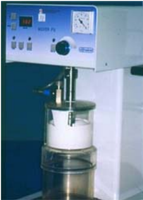
Foto 1 –Preparazione del gesso sottovuoto
