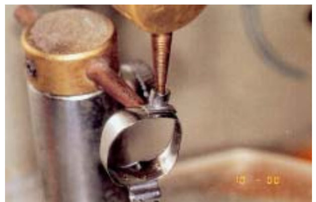
Fig. 2 - Unione tramite puntatrice dei connettori alle bande
