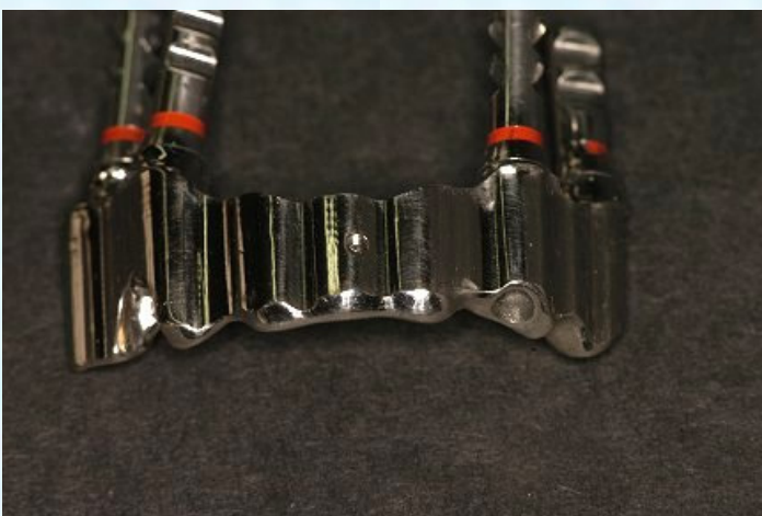
Foto 9 - Particolare della struttura primaria fresata. Si può notare il vano per l'inserimento della vite perfettamente integrato nel fresaggio. Così facendo potremo costruire la meso struttura in maniera corretta
