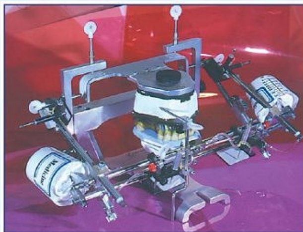
(Foto E) - Immagine del pantografo montato su Vericheck per rappresentare il parallelismo dell'asse cerniera e verifica della RC con Vericheck in protesi fissa.
